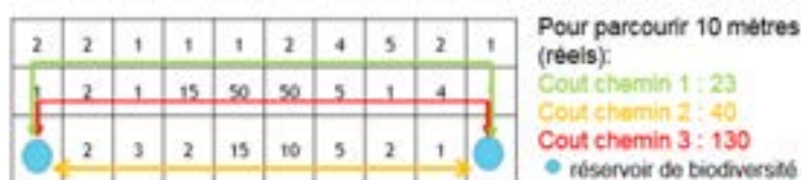
Schéma illustrant la méthode des chemins de moindre coût pour relier deux réservoirs séparés à vol d'oiseau par 10 mètres. © Biotopie
